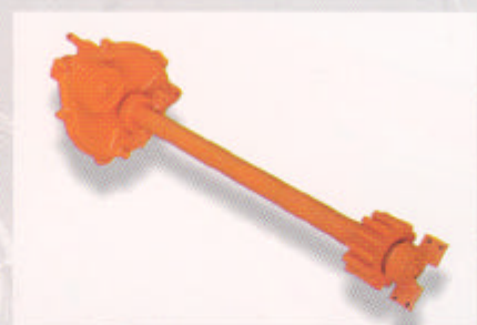
Reductor de engranajes en baño de aceite. Piñón de ataque cementado y templado. Montaje con rodamientos estancos de engrase permanente. Gear reducer unit in oil bath, carburized hardened steel drive pinion. Fitted on permanently greased sealed bearings. Réducteur d'engrenages dans bain d'huile. Pignon d'attaque cimenté et trempé. Montage avec des roulements étanches à graissage permanent.
